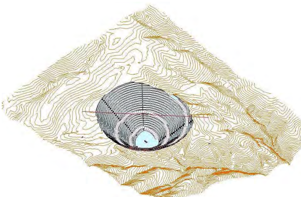
Σχήμα 5.3.2-11. Τρισδιάστατη απεικόνιση του ενοποιημένου ορύγματος Σκουριών στην μέγιστη ανάπτυξή του
