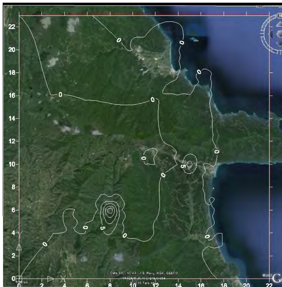
Σχήμα 7.11.8-2 Ισοπληθείς PM 10 (μg/m 3 ) – Φάση ανάπτυξης – ΒΔ άνεμος μέτριας έντασης
