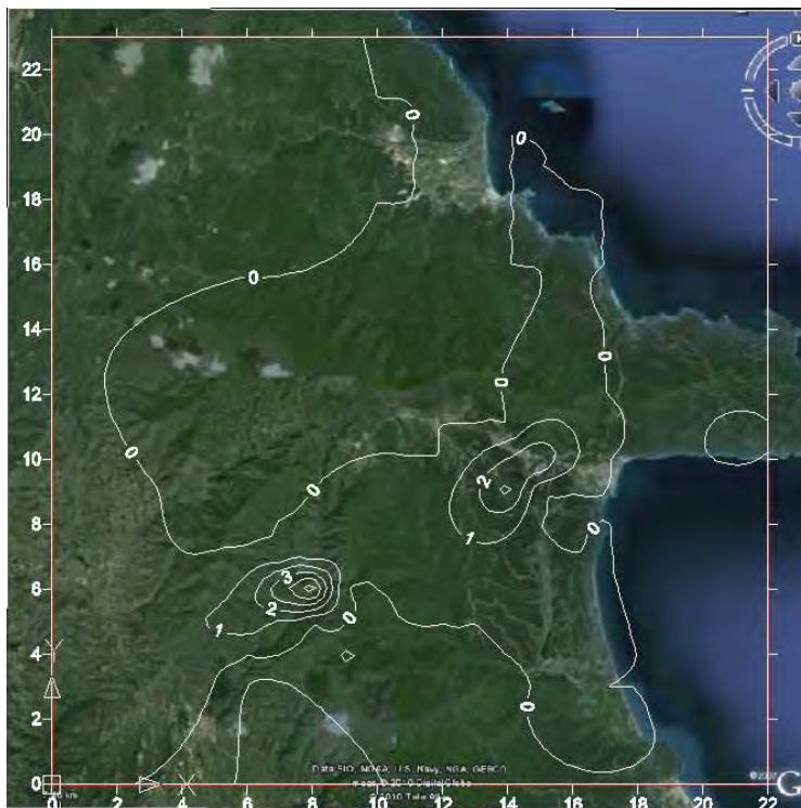
Σχήμα 7.11.6-8 Ισοπληθείς SO 2 (µg/m 3 ) – Φάσεις λειτουργίας Γ & Δ – ΑΒΑ άνεμος μέτριας έντασης
