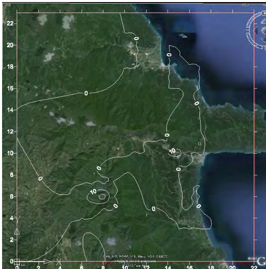
Σχήμα 7.11.8-3 Ισοπληθείς PM_{10} ( \mu g/m^3 ) – Φάση ανάπτυξης – ΑΒΑ άνεμος μέτριας έντασης
